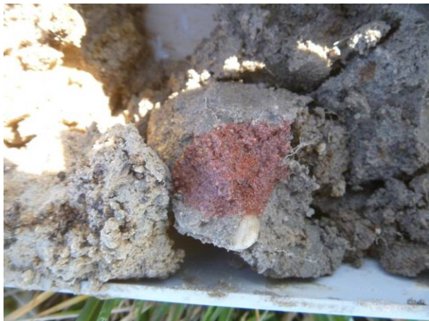
Horizon réductique avec coloration nette du réactif d'orthophénanthroline (sondage n°G1)
