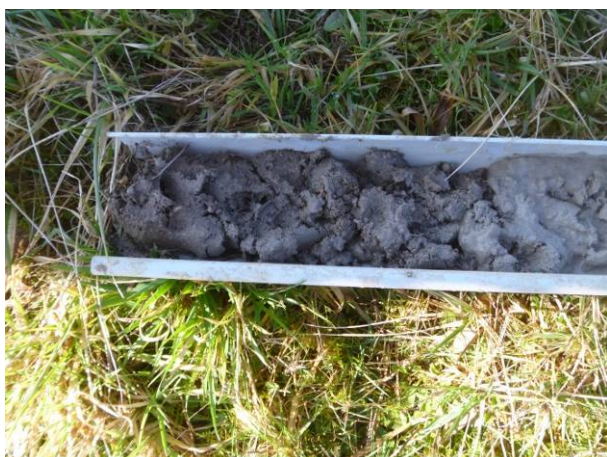
Horizon réductique superficiel surimposant la nappe perchée (sondage n°11)
