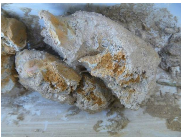
Horizon profond argileux formant une assise imperméable (sondage n°C2)
