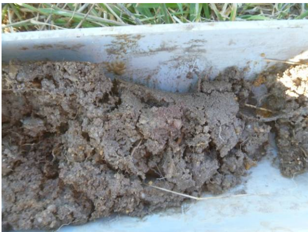
Horizon réductique avec légère coloration du réactif d'orthophénanthroline (sondage n°A5)
