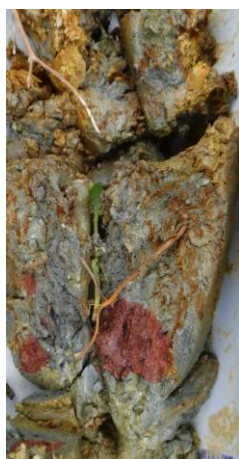
Horizon réductique mis en évidence par l'ortho-phénanthroline
