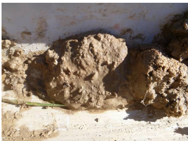
Horizon sableux de surface saturé en eau (sondage n°C2)
