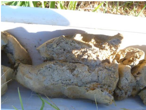
Horizon profond argileux formant une assise imperméable (sondage n°G1)
